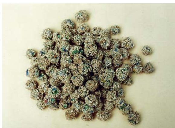
Fig.4 - Aggregato leggero in PET sabbato adatto al confezionamento di calcestruzzi
