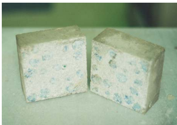
Fig. 5 - Un campione sezionato evidenzia la mancanza di problemi di galleggiamento.
