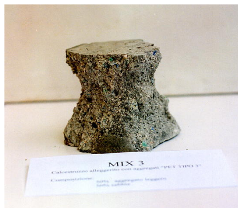
Fig. 6 - La linea di rottura caratteristica di un buon calcestruzzo.
