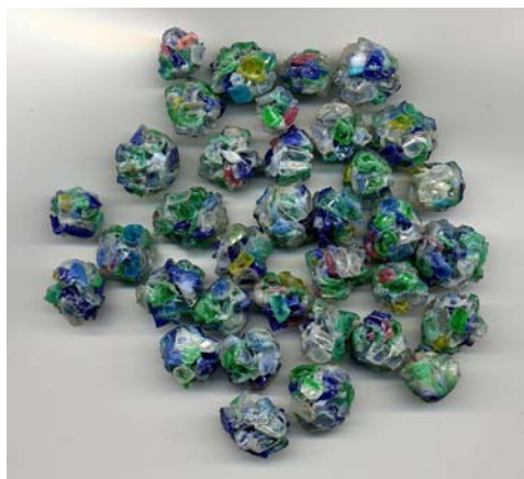
Fig. 7 - L'Aggregato leggero in PET non sabbiato adatto al confezionamento di calcestruzzi leggeri o come riempimento coibente isolante.
