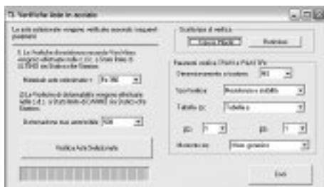
La finestra VERIFICA ASTE IN ACCIAIO
